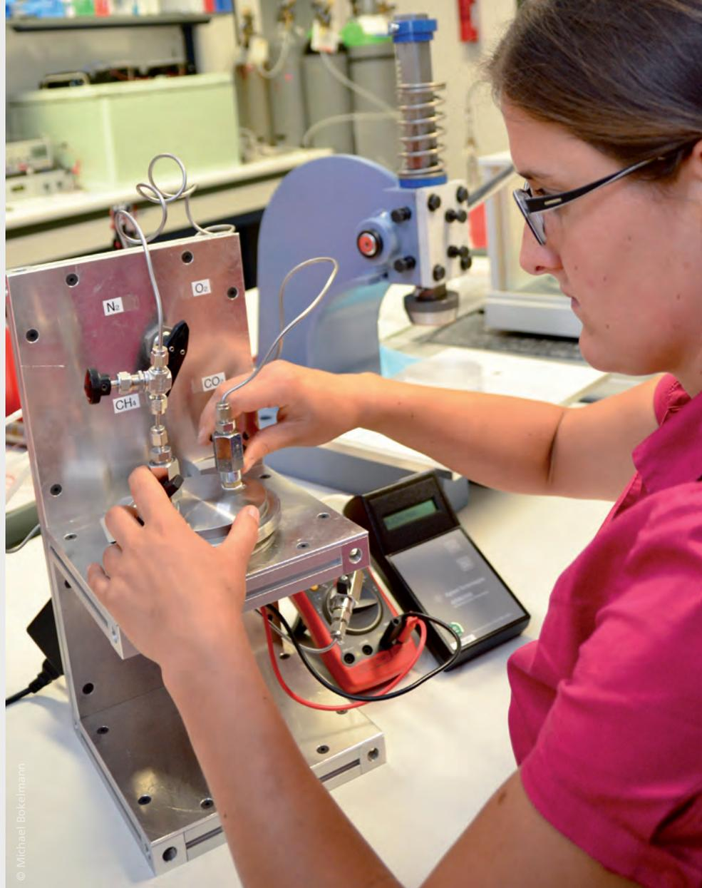
Versuchsaufbau zur Gaserkennung
